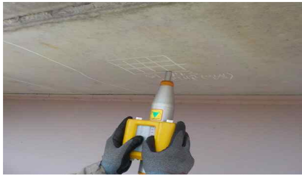
슈미트해머에 의한 반발경도 시험
