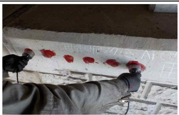
초음파에 의한 강도시험 (하부구조)
